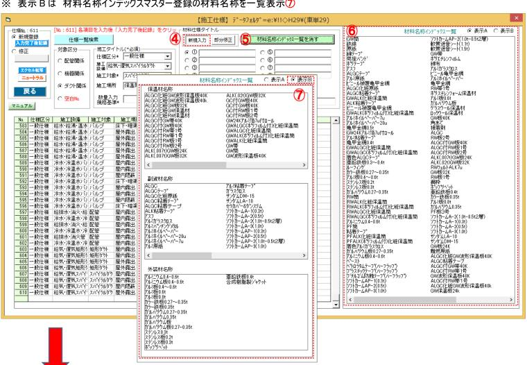
⑧ 仕様タイトルを形成する各材料名称を材料名称インデックス一覧より選択入力します。 (材料名称インデックス一覧にない材料は直接入力も OK です。)
